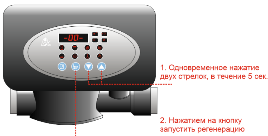
Рис.10 Включение режима регенерации на клапане с автоматической промывкой
